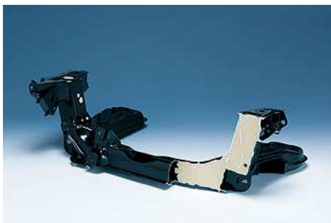
「リジッド・フォームド・サスクロスメンバー」(カットモデル)
