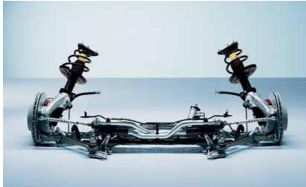
McPherson-Vorderachse mit Querlenkern, Federbeinen beim Boxster S
