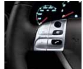
Tiptronic S Wipptaste im Lenkrad
