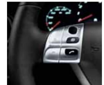
Tiptronic S Wipptaste im Lenkrad
