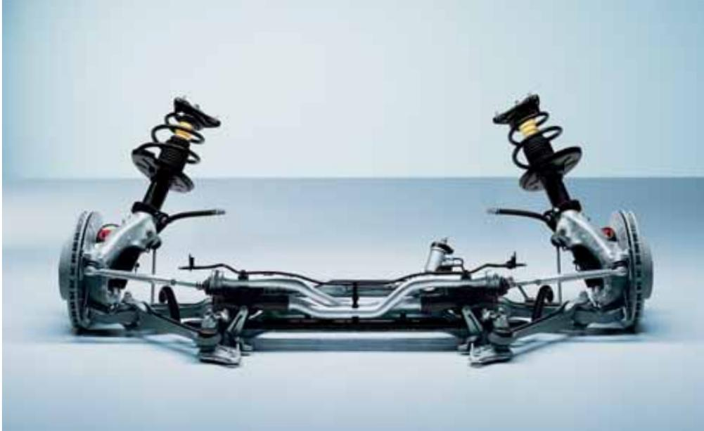
McPherson-Vorderachse mit Querlenkern, Federbeinen beim Boxster S
