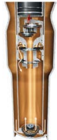
Zugstufe – nur Arbeitskolben, sportlich-straft Abstimmung
