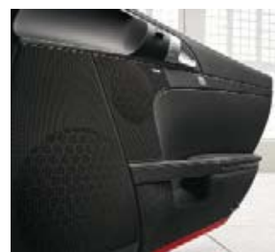
8,0-cm-Neodym-Mitteltonlautsprecher und 20,0-cm-Nd®-Tieftonlautsprecher*
