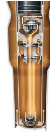
Druckstufe – Arbeitskolben und Bypass, sportlich-komfortable Abstimmung
