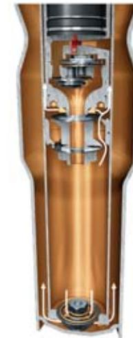
Druckstufe – Arbeitskolben und Bypass, sportlich-straft Abstimmung
