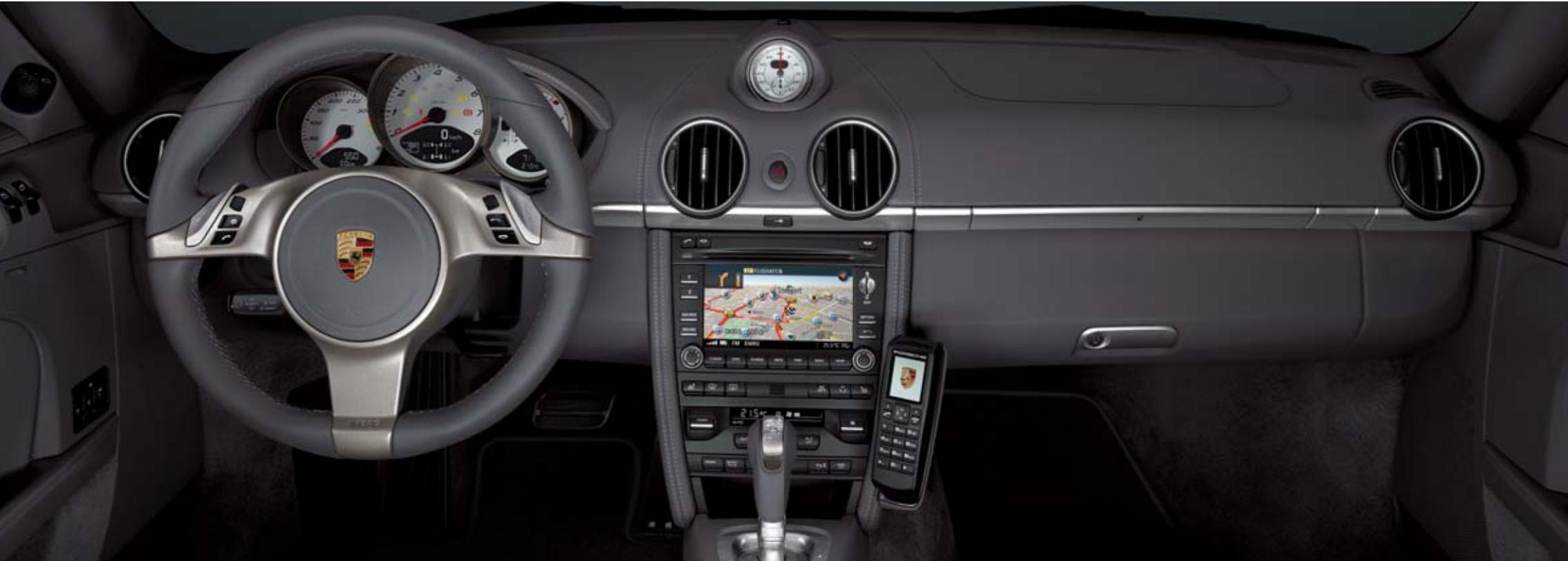
Cayman S Schalttafel mit Sonderausstattungen, u.a. PCM, Aktivhörer, Reifendruckkontrollsystem (RDK), Sport Chrono Paket Plus, PDK
