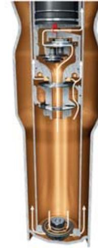
Druckstufe – Arbeitskolben und Bypass, sportlich-komfortable Abstimmung
