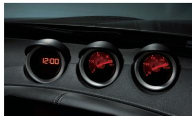
左から時計、電圧計、油温計を配置し、「フェアレディZ」らしさを継承
