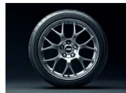
BBS社製 18インチ鍛造軽量アルミホイール* +245/40R18 93Wハイパフォーマンスタイヤ
