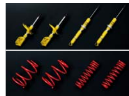
上：BILSTEIN社製 単筒式ショックアブソーバー（フロント／リヤ） 下：Eibach社製 コイルスプリング（フロント／リヤ）
